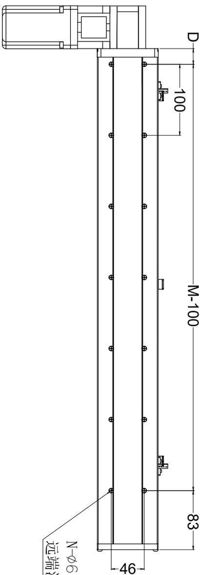
N- $\phi 6.0$  (上锁式安装孔)
